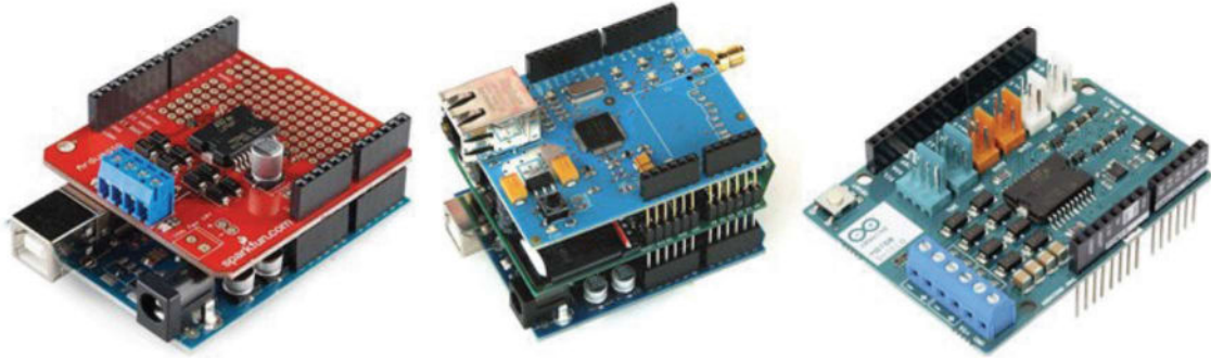
Resim 5.50: Mikrodenetleyici kartlar (Geliştirme kartları) için kalkanlar (Shields)
