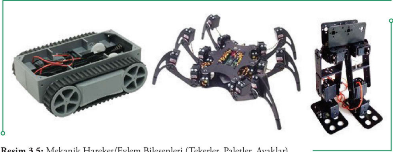
Resim 3.5: Mekanik Hareket/Eylem Bileşenleri (Tekerler, Paletler, Ayaklar)
